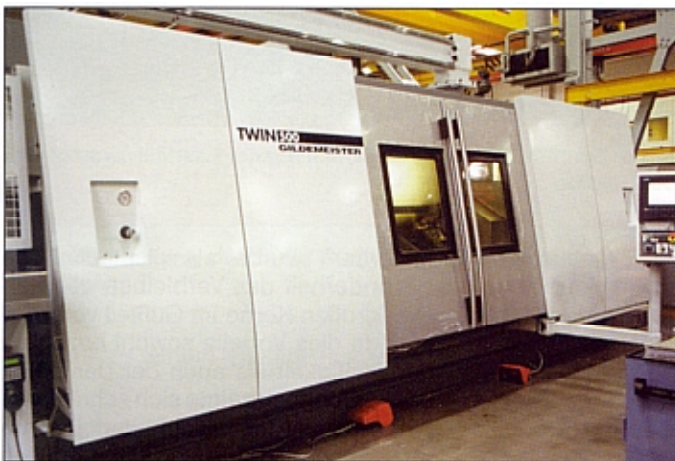
▲ Bild 1: Das neue Hochleistungs-Dreh-Fräszentrum Twin 500 ermöglicht die aufwendige Komplettbearbeitung eines Werkstücks an allen sechs Seiten.
