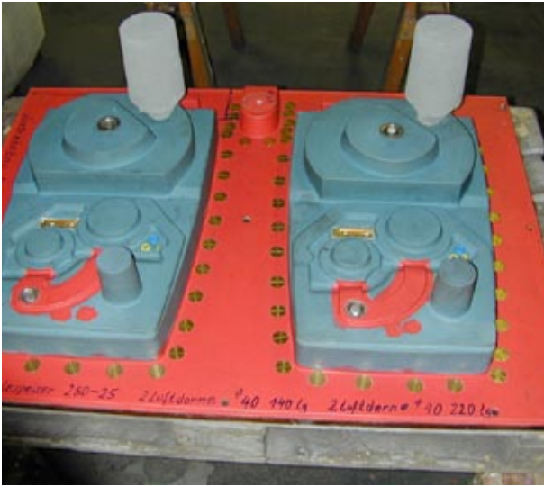
Bild 3: Modelle eines Getriebegehäuses auf einer Formanlagenplatte mit Speisern
