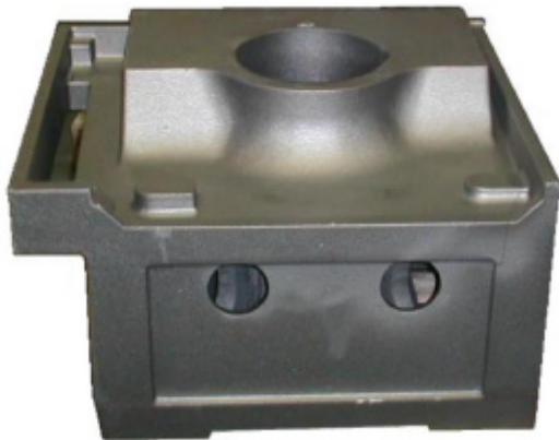
Abbildung 4: Werkzeugmaschinenbett vor der Bearbeitung
