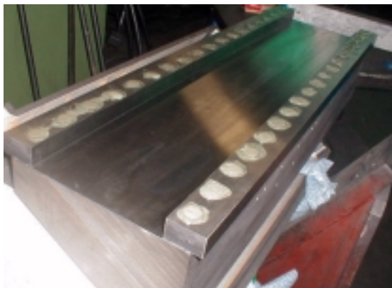
Abb. 5: Einkleben von Stahldeckeln in aufgeschraubte Führungsleisten
