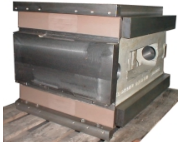
Abb. 2: Schlitten mit Turcite ® -Gleitbelag und Stahlleisten
