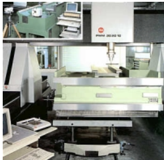
Abb. 6: 3D-Koordinatenmessmaschine (Max. Messbereich [mm]: X = 3.000, Y = 2.000, Z = 1.000; Messunsicherheit \pm 1,5 \mu\text{m} )
