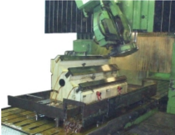
Abb. 1: Maschinenbett mit Konsole Material: EN-GJL-250; Masse: 3000 kg; Abmessungen: ca. 2000 x 800 x 900 mm 3 Lohnbearbeitung: Führungsbahnschleifen
