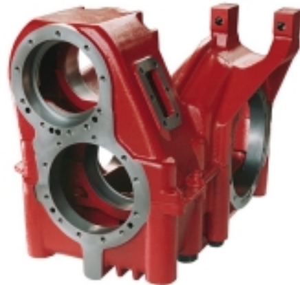
Abb. 6: Fertigbearbeitetes und montiertes Gehäuse für Bahngetriebe Material: EN-GJS-400; Gesamtmasse: 238 kg; Abmessungen: ca. 600 x 600 x 550 mm 3 Lieferumfang: montiert und einbaufertig bearbeitet
