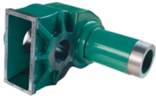
Abb. 5: Fertigbearbeitetes Gehäuse für Mähreschergetriebe Material: EN-GJS-400-18-LT; Masse: 210 kg; Abmessungen: ca. 700 x 500 x 650 mm 3 Lieferumfang: einbaufertig bearbeitet
