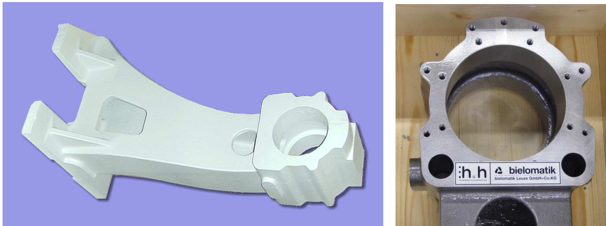
Bild 6: Links: Grundierter Rohguss in kurzer Ausführung. Rechts: Detailansicht des bearbeiteten Ausstellungsstückes. Material: EN-GJS 400-15, Gewicht: 170 kg
