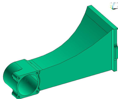
Bild 2: Für Tragarmkonstruktion verfügbarer Bauraum
