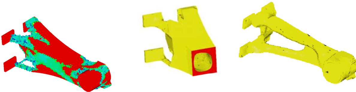
Bild 3: Ergebnis der Topologieoptimierung (Restvolumen im FEM-Modell (links), geglättete Gestaltungsvorschläge aus der Topologieoptimierung ohne (Mitte: Querschnitt) und mit Fertigungs-Restriktionen (rechts))
