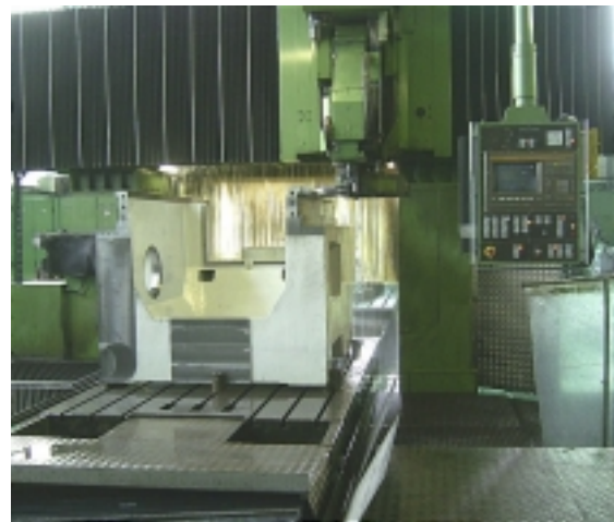
Abb. 1 Schleifbearbeitung am Bett einer HSC-Fräsmaschine
