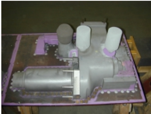
Modell eines Getriebegehäuses auf Form-anlagenplatte mit Speisern und Kühlkokillen
